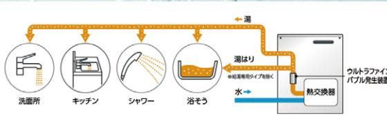
給湯器にウルトラファインバブル発生装置を搭載。
